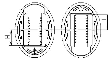
Шляпка болта эксцентрична, поэтому позволяет устанавливать сиденья на унитазы с разным межосевым расстоянием С (Вид А см. на обороте)
